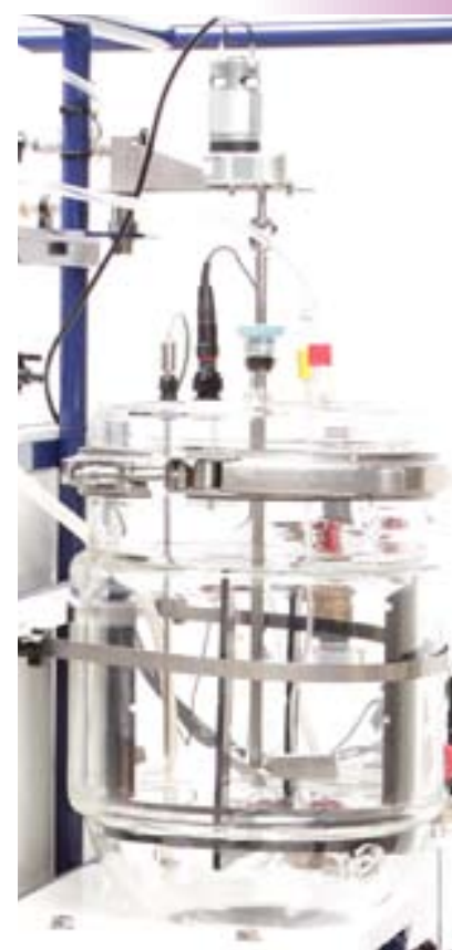
BE4 configurado como CSTR (Reactor Continuo de Tanque Agitado)
